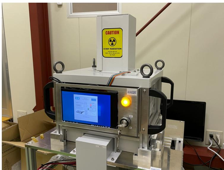
図 4.7: クーリングボックスに設置された x 線照射装置
