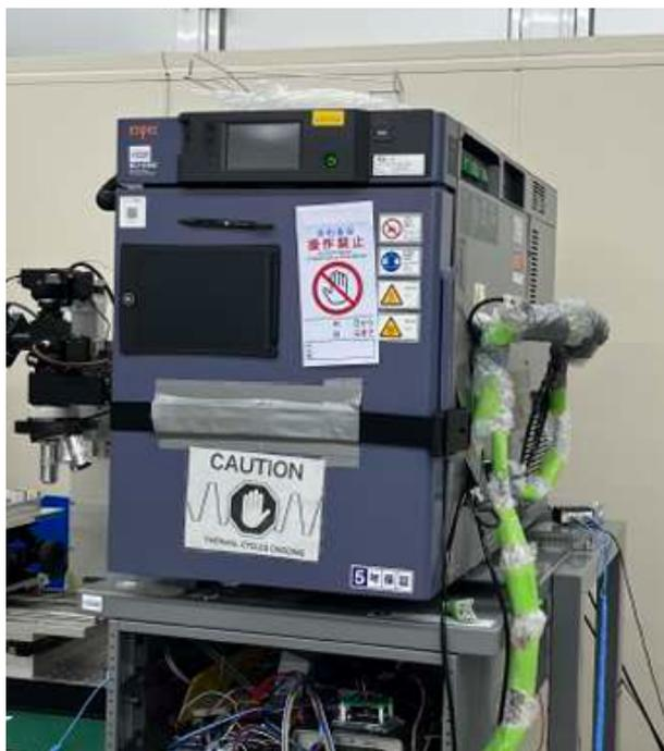
図 4.8: 熱サイクル試験用恒温槽
