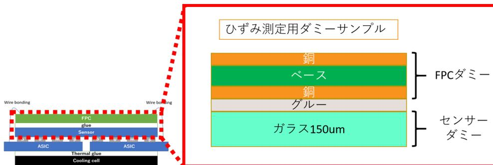
図 4.9 ダミーサンプルのイメージ図:ガラスをセンサーダミーとして、ベースと銅の層を FPC ダミーとしてサンプルを作成した。
