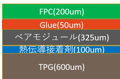
図 6.4 RD53A モジュール簡素モデルの概念図
