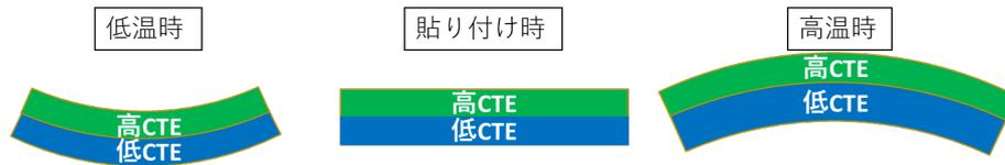
図 3.14 CTE の異なる材料を貼り合わせた時の熱変形
