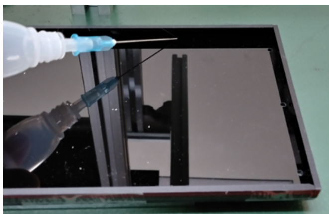
図 4.66 接着剤によるアクリル板の接着の様子
