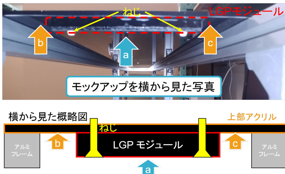
図 4.53 モックアップを横から見た写真と概略図。それぞれの矢印が測定箇所であり、a はモジュール中央、b,c はそれぞれモジュール両脇の上部アクリルを指す
