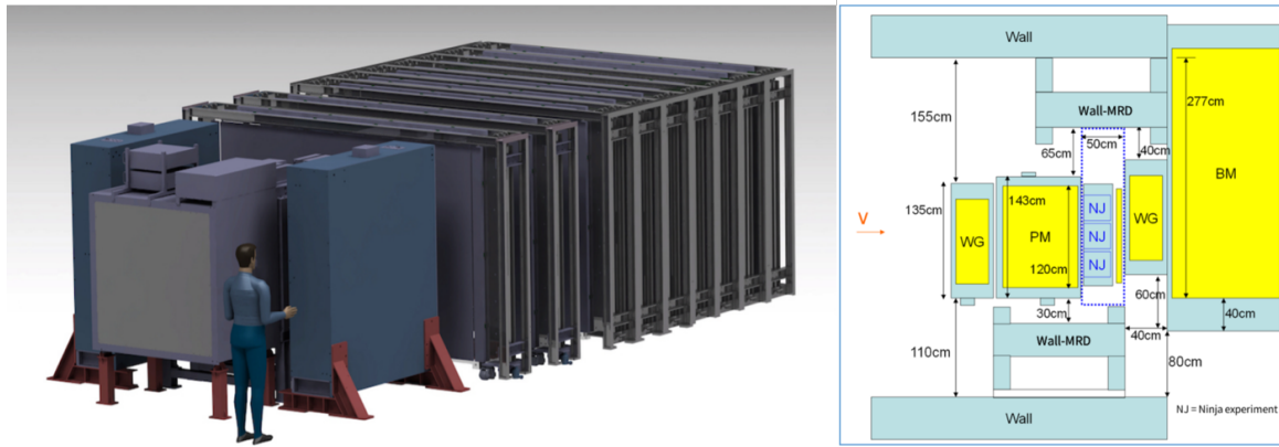
図 2.10 左が WAGSCI-BabyMIND の外観図 [56] で右が上面図 [55]。WG が WAGSCI モジュール、BM が BabyMIND、PM が PROTON モジュール、NJ は NINJA(Neutrino Interaction research with Nuclear emulsion and J-PARC Accelerator) 実験 [57] の検出器を意味している。
