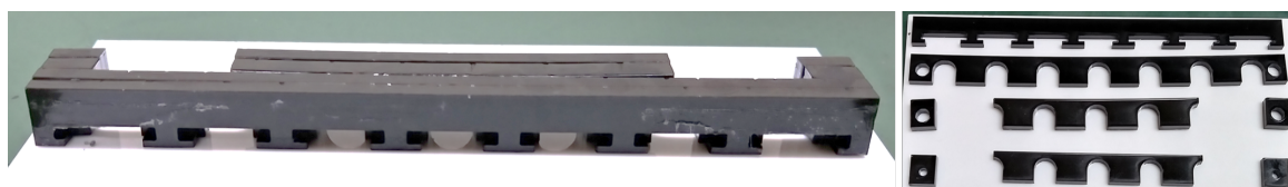
図 4.31 開発したコリメータの写真。左が接着後で、右がプレートごとの写真である。
