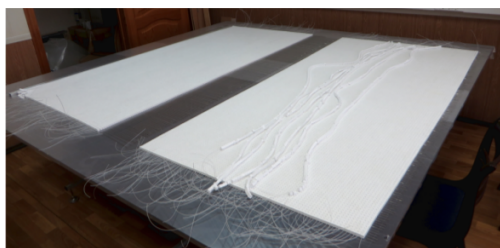
図 3.15 釣り糸を通したシート状のシンチレーターキューブ [72]
