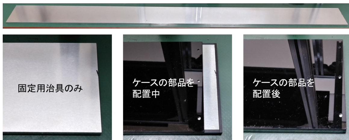
図 4.64 黒アクリルケースの仮固定用治具の試作品。上が仮固定用治具のアルミ板の全体写真で、下が右端の拡大写真。
