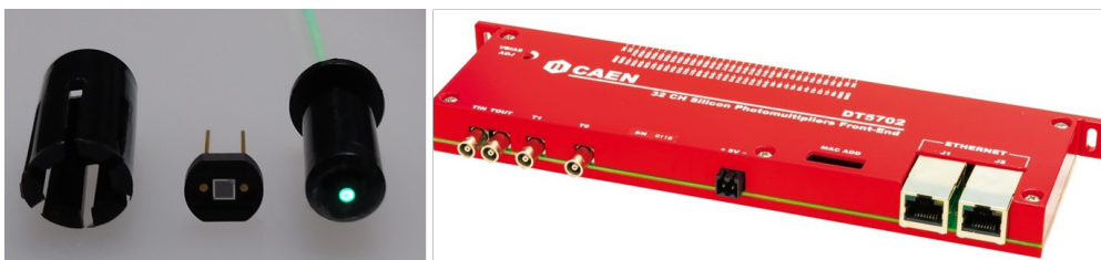
図 4.22 MPPC と波長変換ファイバーの写真 (左) と DT5702 の写真 (右)[87]。左の中央が MPPC(S13360-1325CE)、その両側は波長変換ファイバーと GOMI コネクター (General Optical MPPC Injection Connector)[89] である。
