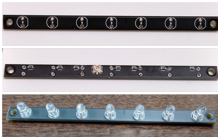
図 5.4 最終版の LED 基板の写真。上は LED 側、真ん中はケーブル側から見た写真であり、下は LED を取り付けた後の LED 基板である。
