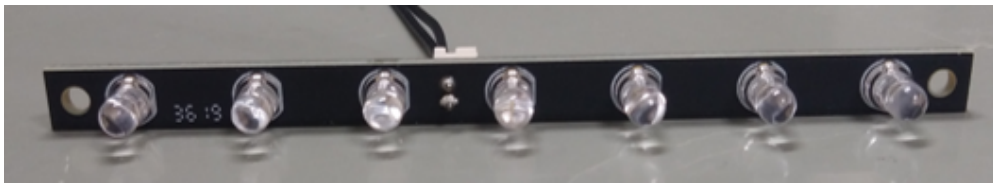
図 4.21 LED 基板と NSPB300B の写真。LED は 1cm 間隔で取り付けられており、基板の長さは 74 \times 5 \times 1.6 mm である。
