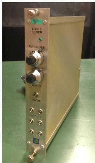
図 4.11: ライトパルサーモジュールの外観。信号の入力があると右上のランプが点灯する。
