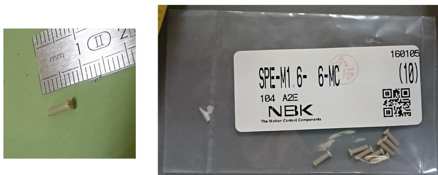
図 5.9: 使用したネジの外観。Belle II 測定器内部は高磁場がかかるため、磁場の影響を受けない樹脂製を採用した。
