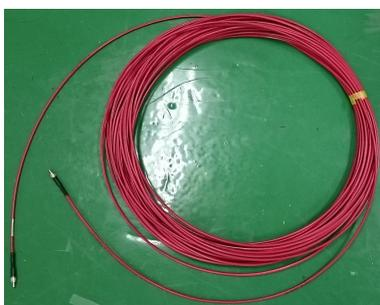
図 4.13: ファイバーパッチケーブル (40m) の外観
