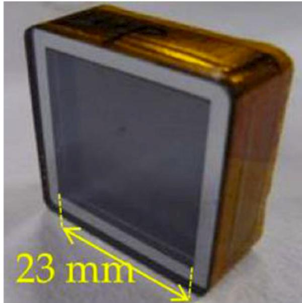
図 2.14: MCP-PMT の外観。
