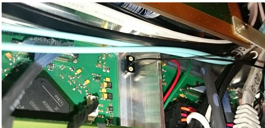
図 5.8: 分岐ファイバーの先端が ARICH の構造体に固定されている様子。2 点でねじ止めをしている。
