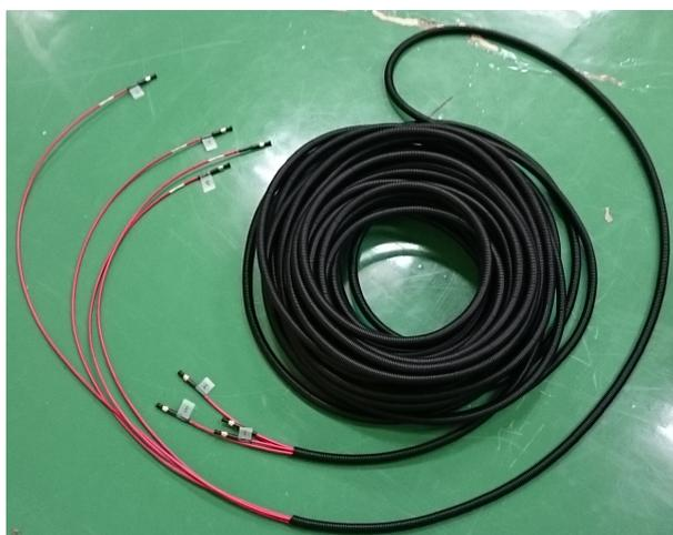
図 5.11: 40m の延長用ファイバーをコルゲートチューブで結束・保護した様子。
