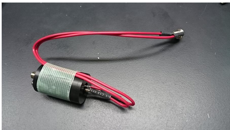
図 5.2: 接続具外部に出した LED の導線を延長し、LEMO レセプタクルコネクタに固定した様子。
