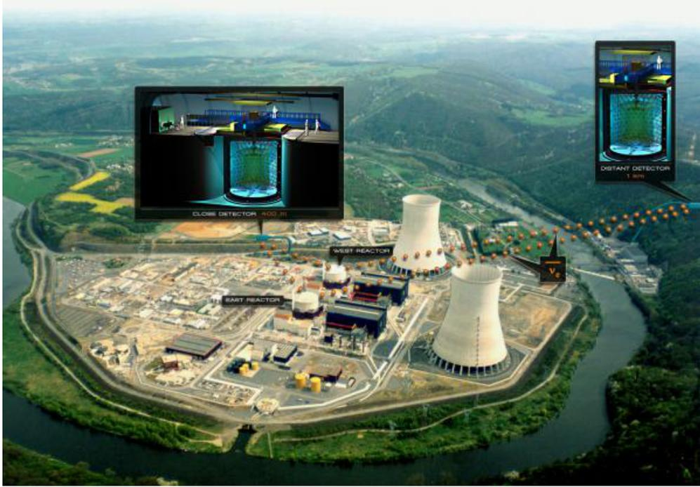
図 3.2 Double Chooz 実験の原子炉と後置検出器、前置検出器の位置関係
