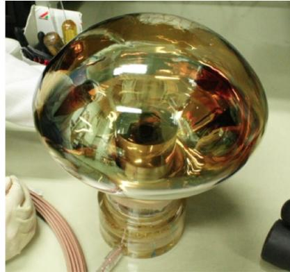
図 3.6 バッファ層に設置されている浜松ホトニクス社製の 10 inch の光電子増倍管 R7081 MOD
