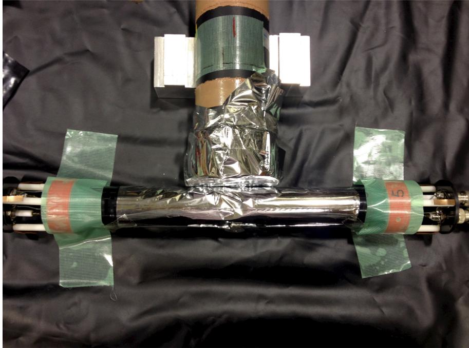
図 6.8: 陽電子による Plastic Scintillator の発光量測定実験のセットアップ
