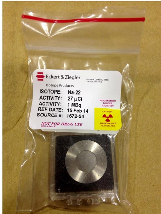
図 6.6: チタン製陽電子線源  $^{22}\text{Na}$
