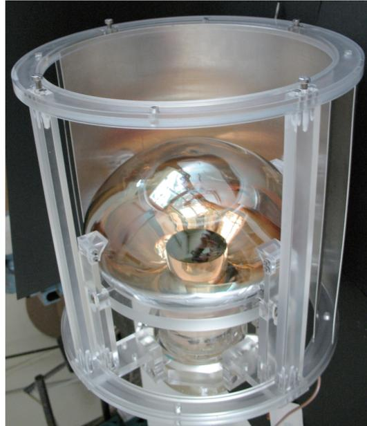
図 2.13: サポートと  $\mu$ メタル (写真背面の灰色の部分) が取り付けられた PMT。実際は側面全体を  $\mu$ メタルで囲む
