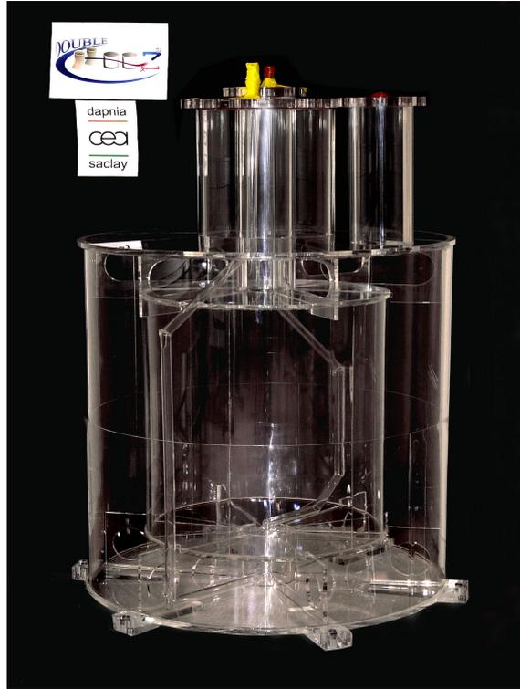
図 2.9: Target,  $\gamma$ Catcher のアクリル模型
