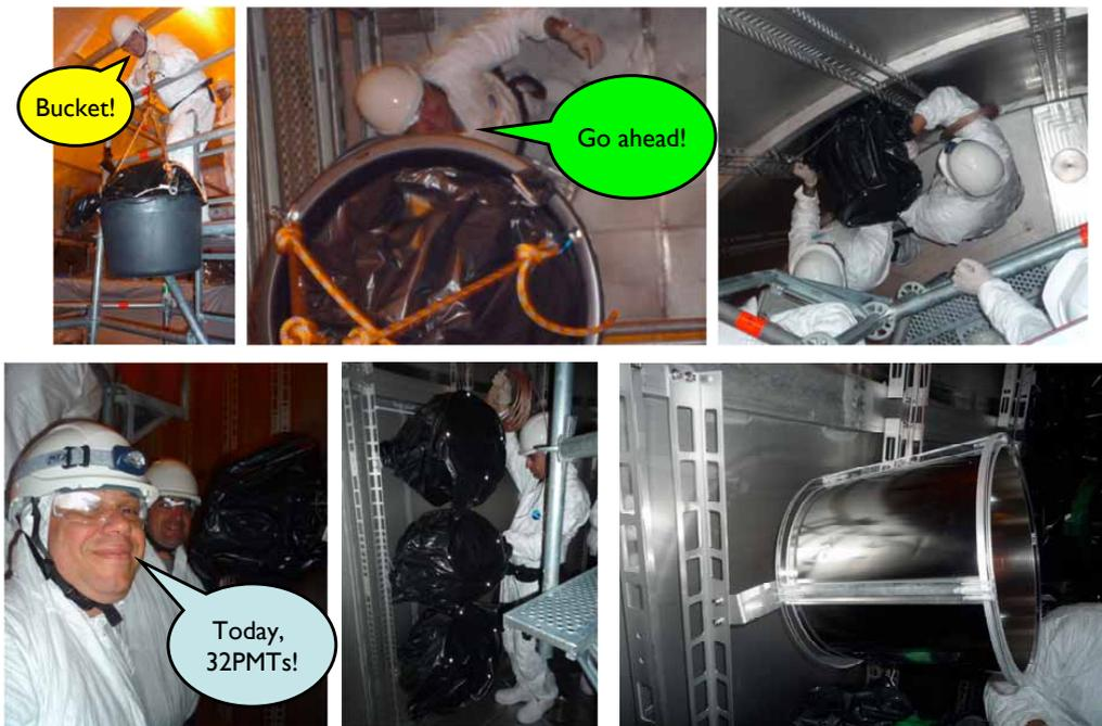
図 2.10: 2009 年 8 月 Far 検出器において側面の PMT 設置中の写真
