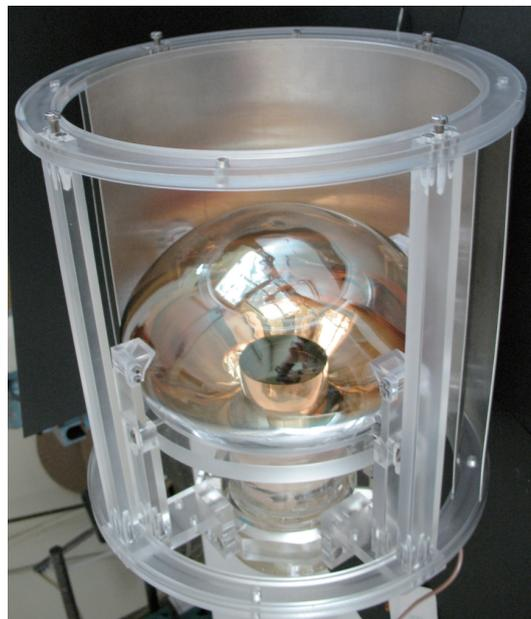
図 2.11: PMT のサポート構造
