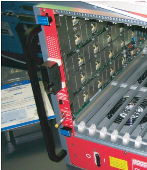
図 5.1: CAEN 社製の多チャンネル高電圧電源のメインフレーム SY1527(左) と、高電圧電源のモジュール A1535(右)
